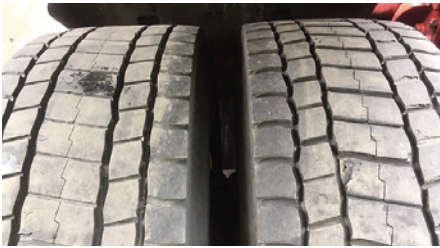
Ingen skader på dæksider eller slidbaner.
