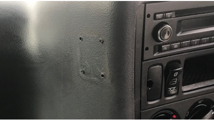
Skruehuller i instrumentpanelet.
