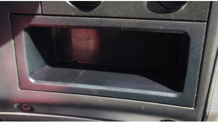
Manglende, ødelagte eller defekte paneler på instrumentpanelet.
